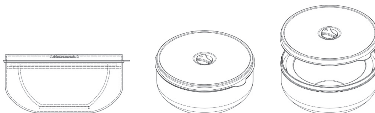
รูปที่ 5 รูปทรงบรรจุภัณฑ์ที่ออกแบบให้ภาชนะชั้นในมีช่องตะแกรงที่มีความถี่ที่ยอมให้น้ำผ่านแต่ป้องกันการร่วลงของเมล็ดข้าวขณะหุงต้ม ฝาเปิดได้ออกแบบให้มีช่องสำหรับเปิดปิด และพัฒนาภาชนะชั้นนอกให้ดูเป็นคล้ายขามเพื่อสะดวกในการจับถือและกระจายความร้อนได้ดีในขณะหุงต้ม ที่มา: ผู้วิจัย (2559)
